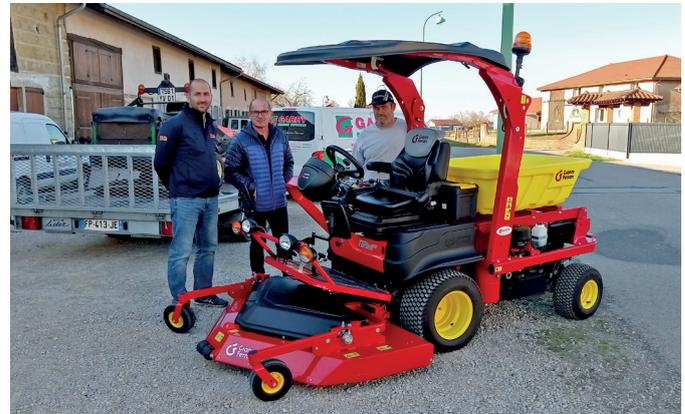
Après de nombreuses années de service et face à une grosse réparation à prévoir sur la barre de coupe, le renouvellement du tracteur tondeuse s'avérait nécessaire. La commune a donc opté pour un modèle doté de 26 chevaux, équipé d'un système « mulching » et d'éjection arrière. Son coût s'élève à 21 000 € TTC. Ainsi, nous pourrons entretenir au mieux les espaces verts de la commune par tous les temps.
