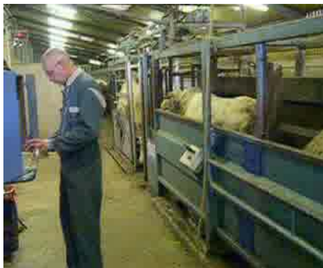
Le système de pesée et le lecteur de boucles électroniques sont connectés à l'ordinateur. Un signal sonore est émis par le lecteur quand il détecte une boucle électronique sur l'animal. Le poids et le numéro de l'animal sont saisis automatiquement.
